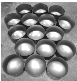
Рис. 8. Заготовки, які отримані витягуванням
