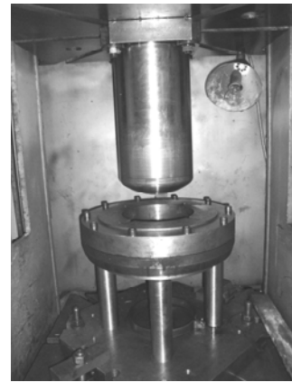
Рис. 7. Штамп для витяжки, який встановлено на гідравлічному пресі ДБ2432 зусиллям 1,6 МН
