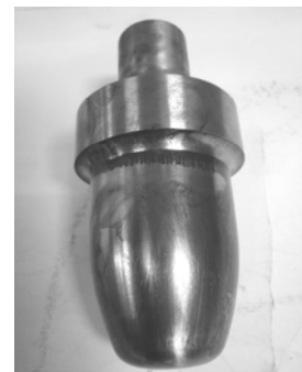
Рис. 9. Матриця та пуансон для відборування
