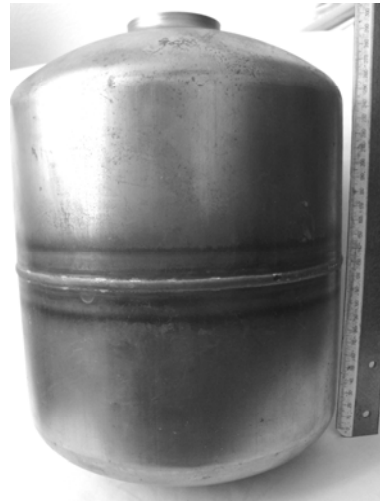
Рис. 11. Виріб «балон», який зварено з двох отриманих деталей
