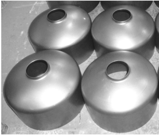
Рис. 10. Відбортовані складові деталі виробу «балон»
